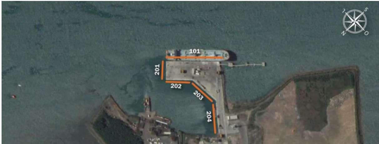
Figura 76 - Berços de Atracação – Porto de São Sebastião Fonte: Plano Mestre do Porto de São Sebastião (2018)
