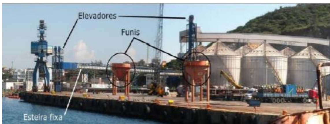
Figura 40 - Sistema de Descarregamento e Armazenagem de Malte – Porto do Forno Fonte: Plano Mestre do Porto do Forno (2014)
