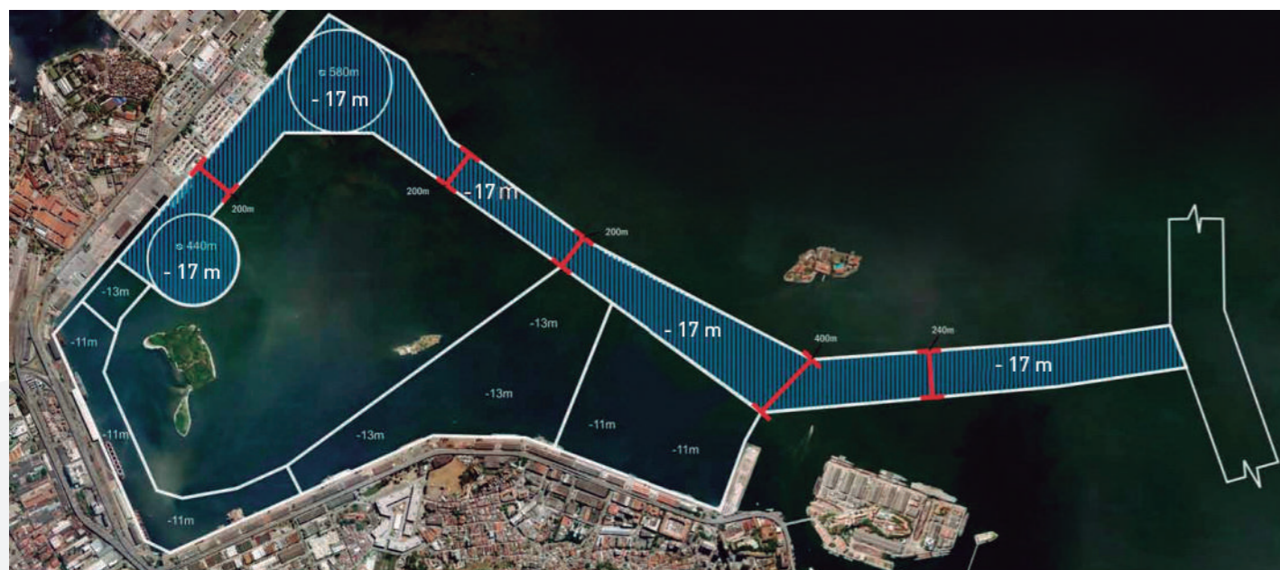
Figura 42 - Canal Principal do Porto
