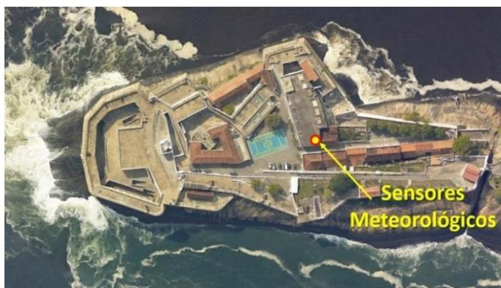
Figura 13. Esquema de localização de instalação da estação meteorológica da Fortaleza de Santa Cruz, no teto do prédio do Comando (AD-1).
