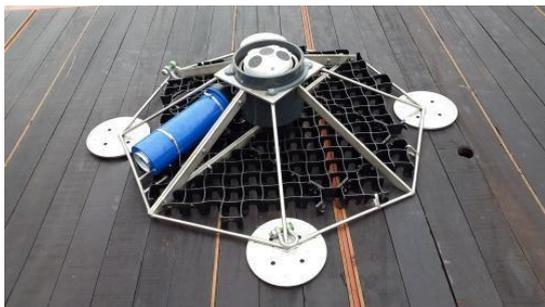
Figura 18 - Exemplo de estrutura metálica para o fundeio do ADCP, com bateria extra para viabilizar fundeios de longa duração.
