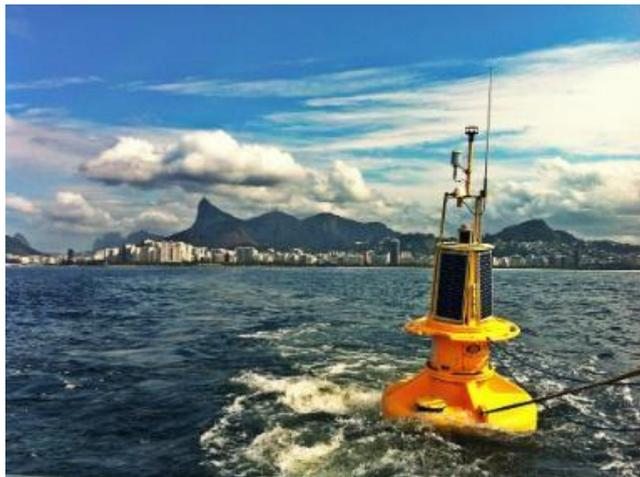
Figura 20. Boia AXYS *Watchkeeper* sendo rebocada na Baía de Guanabara/RJ (*site SiMCosta*).
