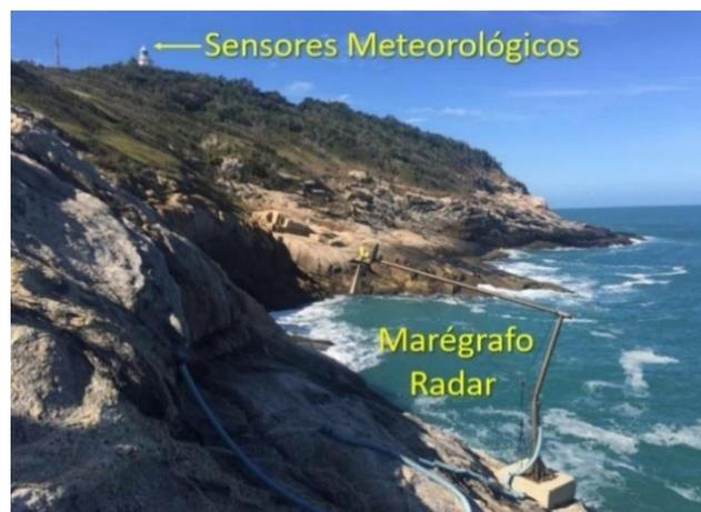
Figura 7 – Detalhe dos locais de instalação dos sensores da estação meteomaregráfica da Ilha Rasa.
