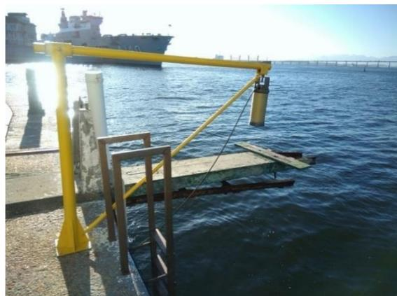
Figura 16. Sensor radar *Kalesto* e o tubo tranquilizador do sensor de boia e contrapeso *SE 200*, ambos da *OTT*, da atual estação maregráfica da Ilha Fiscal.
