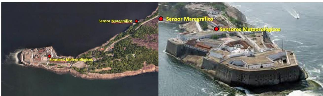
Figura 10. Esquema do posicionamento dos sensores da estação meteomaregráfica da Fortaleza de Santa Cruz.
