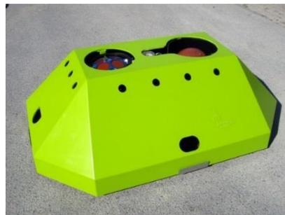
Figura 19 - Exemplo de estrutura metálica para o fundeio do ADCP, com bateria extra para viabilizar fundeios de longa duração.
