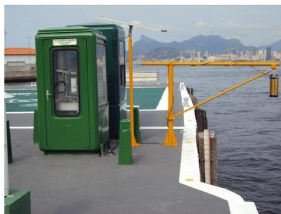
Figura 5. Marégrafo radar da estação maregráfica convencional da Ponta da Armação.
