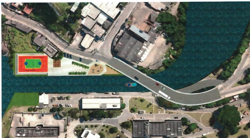
Figura 20A: Proposta de revitalização urbana da Ilha da Conceição, com implantação de um canal de 300m de extensão, 20m de largura e profundidade de 3m (Fonte: INPH).
