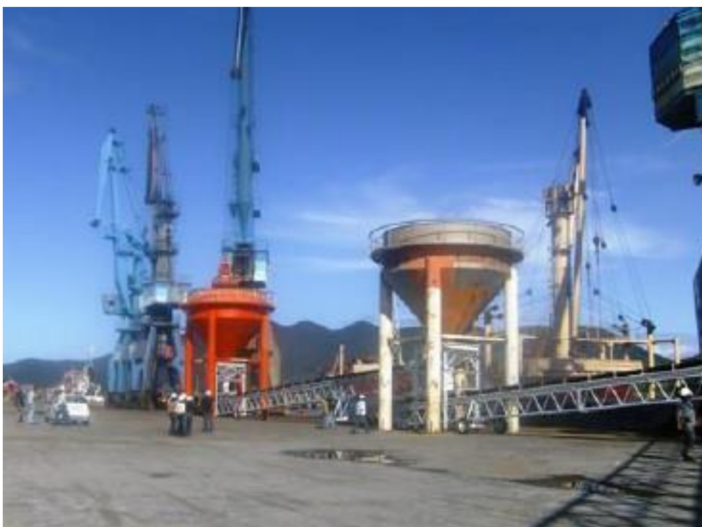
Figura 42 - Sistema de Descarregamento e Armazenagem de Malte – Porto do Forno Fonte: Plano Mestre do Porto do Forno (2014)
