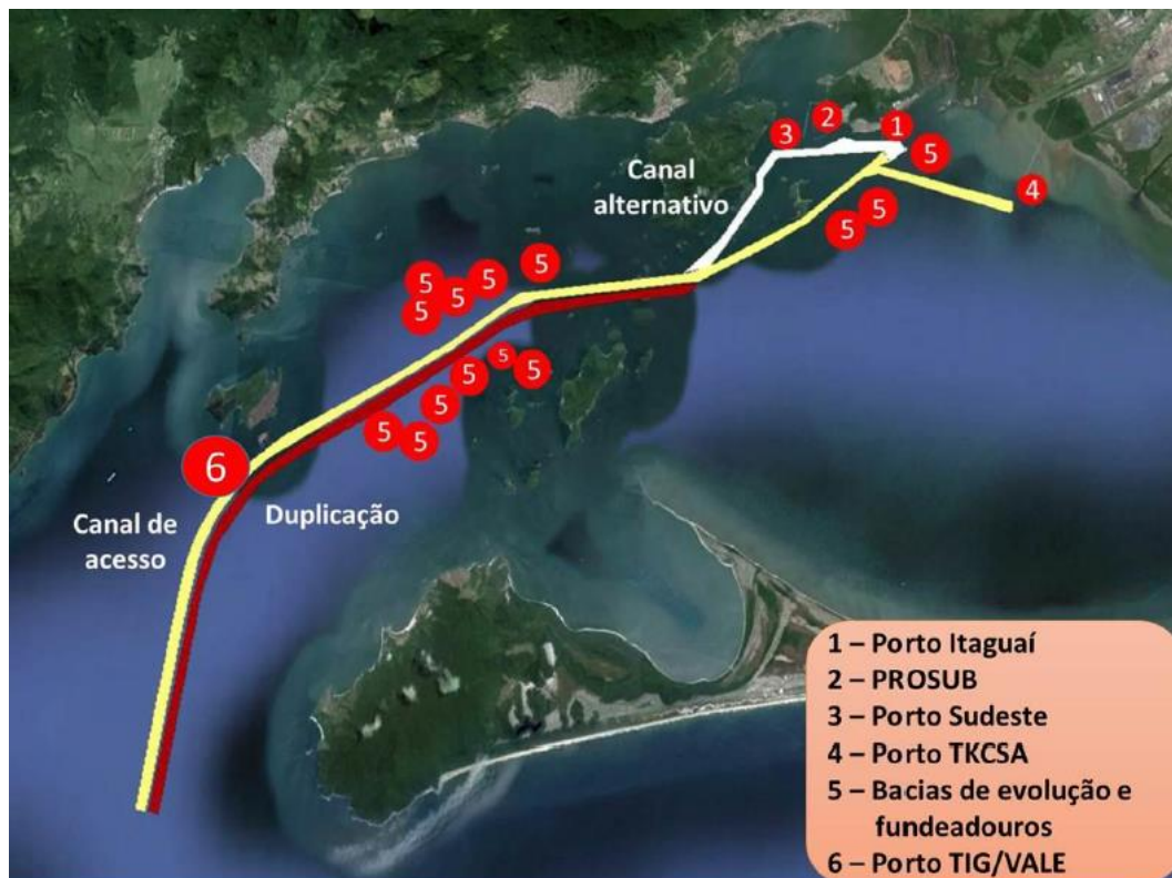
Figura 116 - Proposta de Duplicação dos Canais de Acesso ao Porto de Itaguaí via Canal Derivativo Fonte: FIRJAN (2015)
