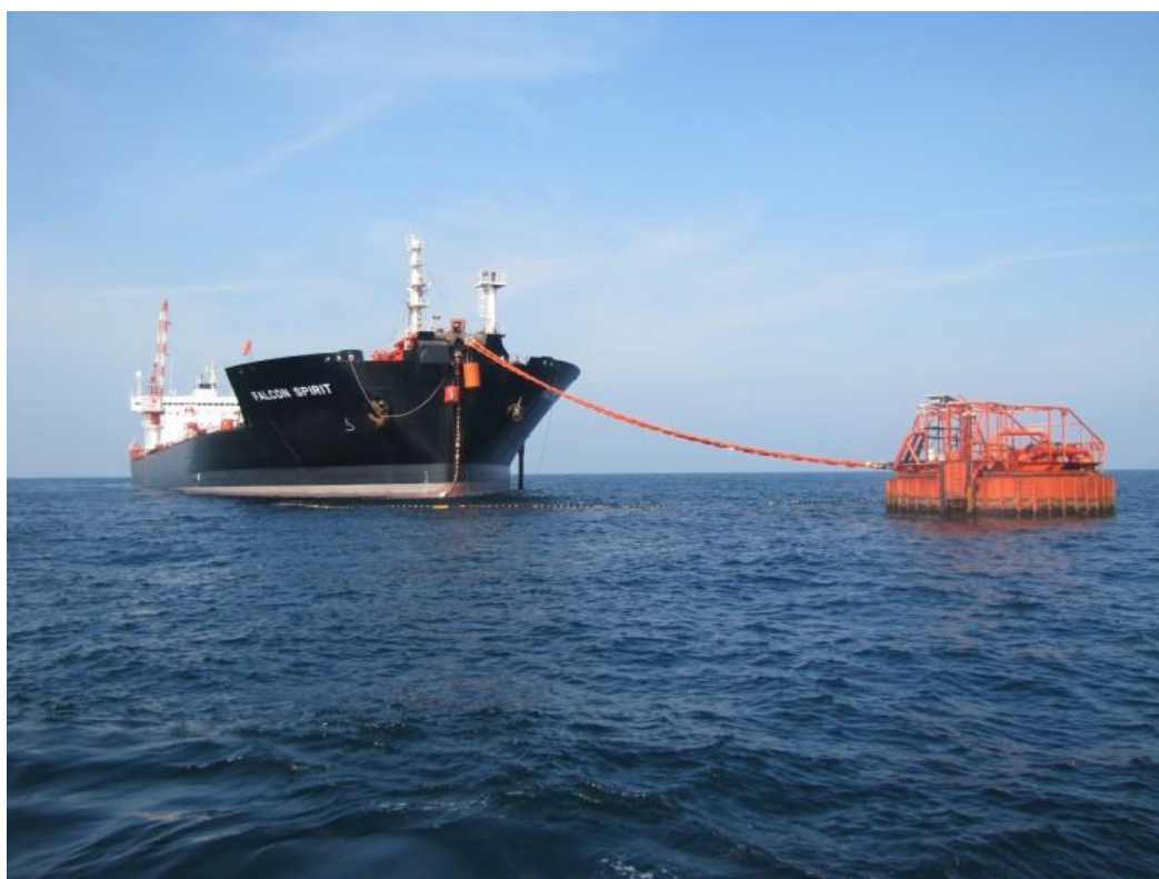
Figura 129 – Unidade de armazenagem flutuante (FSO) implantada no Qatar
