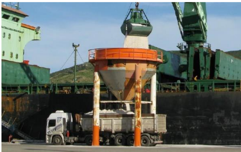
Figura 39 - Descarga Direta de Sal – Porto do Forno Fonte: Plano Mestre do Porto do Forno (2014)
